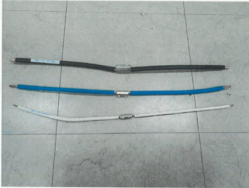
BSLB-6/25 접속 16 mm 2 전선(흰색), BSLB-10/50 접속 50 mm 2 전선(청색), BSLB-35/95 접속 70 mm 2 전선 (흑색) 〈 직선이형접속재 인장력 시험 시료 〉
