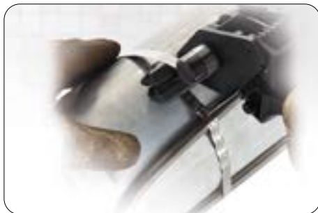
HEAT TRACING 스테인리스 스틸타이
